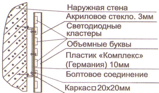
Схема крепления вывески
